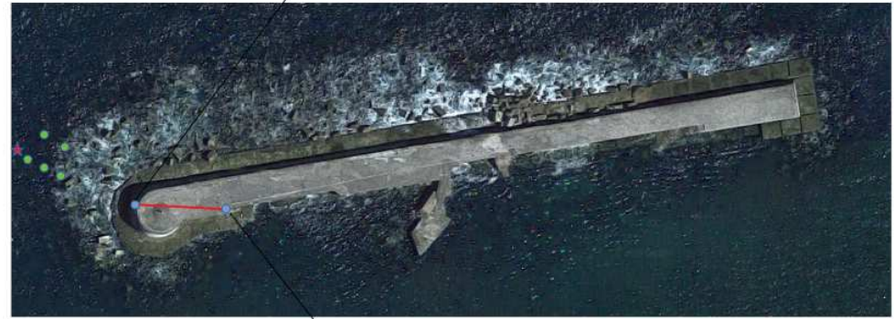
● Capteur de pression ★ Courantomètre Mesures hydrodynamiques (pression dynamique aux six capteurs et vitesses au courantomètre) automne 2018
