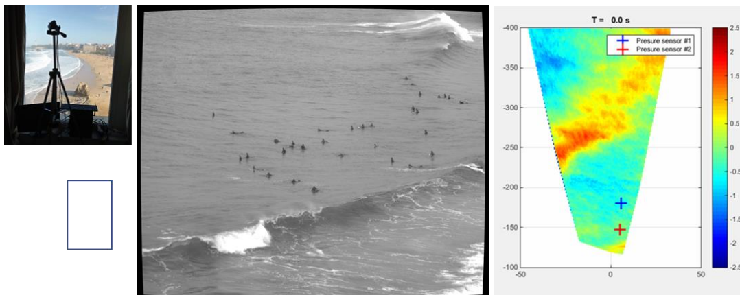
Figure 4: Les deux caméras du système de mesures stéréo-vidéométrique (gauche), prise de vue de l'une des caméras (centre) et un exemple de reconstruction de la surface de l'eau obtenu (droite).
