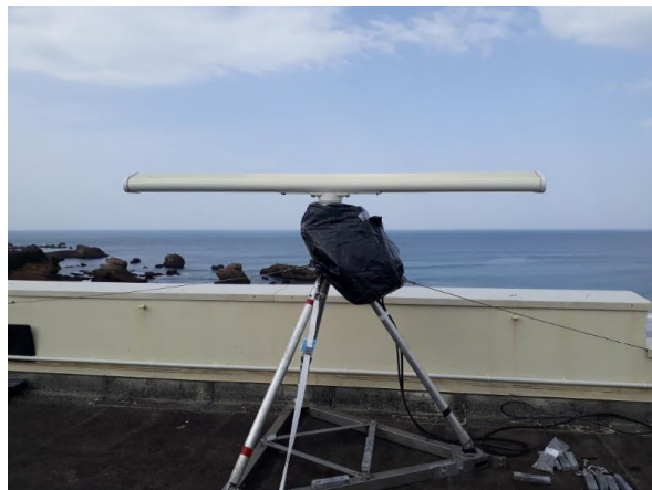
Figure 3: Installation du radar X-band sur le toit du Casino de Biarritz pour mesurer le courant de surface et les vagues à distance.
