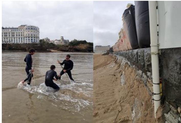
Figure 2: Déploiement de capteurs de pression pour mesurer les vagues et le niveau d'eau en zone intertidale (gauche) et les franchissements en haut de plage (droite).
