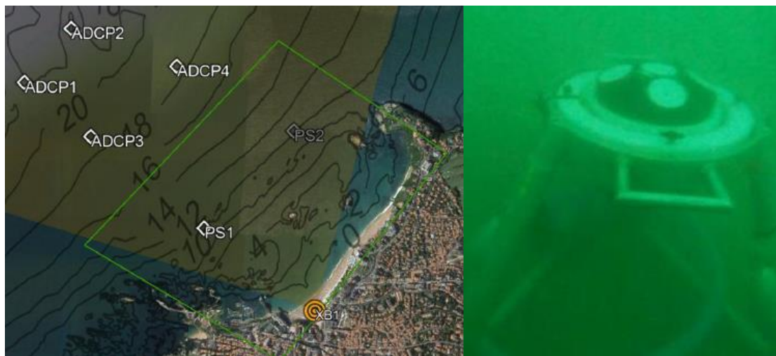
Figure 1: Gauche : position des capteurs sur le fond marin et du radar X-Band déployés durant la campagne MARLIT 202. Droite : photographie sous-marine d'un des capteurs sous-marins mesurant le courant, le niveau d'eau et les vagues.
